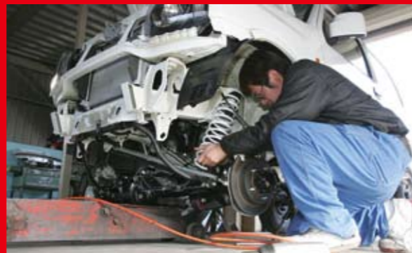
7 フロントの脚まわりの作業。フロントコイルを入れていく。コイルは4本とも長さや通しの間隔を揃えないとだめ。
