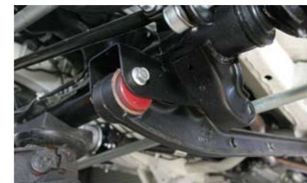
5 リフトアップによるキャスト角補正のため、アームにキャスト角補正プッシュを取り付ける。プレス機を必要とする、やや面倒な工程。
