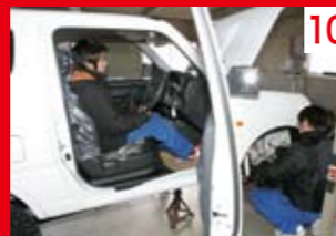
10 ブレーキホースの交換等があったため、ブレーキのエア抜き作業は必須。
