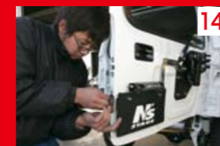
14 リアゲートのスペアタイヤ&ナンバー移動キットの取り付け。只今ナンバー灯の配線中。
