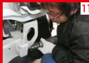
11 スキッドプレートの取り付けには、フレームへの穴開け加工が必要。
