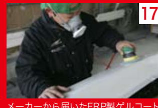
17 メーカーから届いたFRP製ゲルコート仕上げのバンパーを前処理中。実はこの工程が一番手間暇がかかる。
