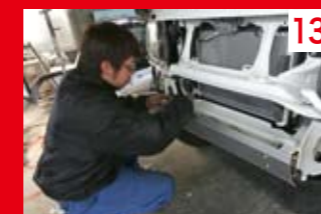
13 その穴を使ってアルミスキッドプレートを取り付け。タニグチ製は強度充分!
