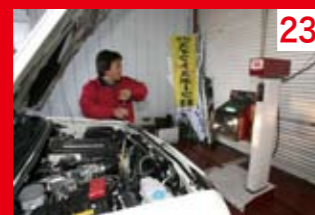
23 リフトアップするとズレる光軸をココで調整。やはり、結構ズレてましたね。
