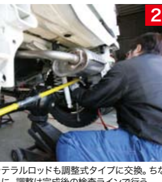
2 ラテラルロッドも調整式タイプに交換。ちなみに、調整は完成後の検査ラインで行う。
