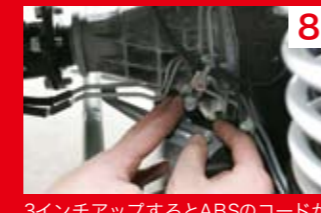
8 3インチアップするとABSのコードが引っぱられて危険。これを対策するステーを取り付ける。
