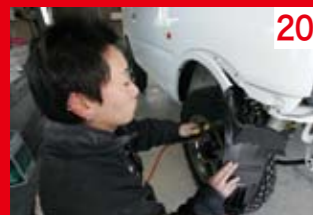
20 フロントバンパー取り付け前にインナーフェンダーの邪魔な部分をカット。
