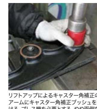
5 リフトアップによるキャスト角補正のため、アームにキャスト角補正プッシュを取り付ける。プレス機を必要とする、やや面倒な工程。
